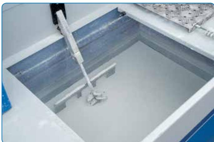
La séparation des matières solides et de l'eau claire est réalisée. On peut maintenant procéder au filtrage de l'eau avant l'évacuation par les canalisations.
