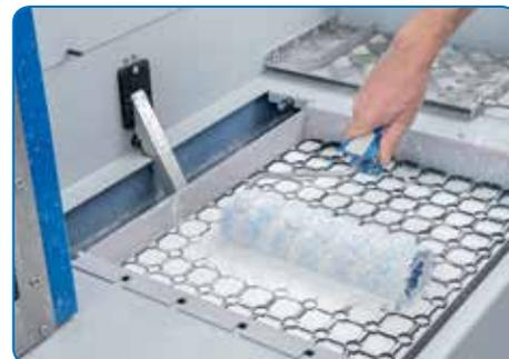
**4** Poste de pré-lavage des rouleaux : pré-lavés, les rouleaux seront nettoyés encore plus vite dans le TurboWash, ce qui entraîne également des économies d'eau.
