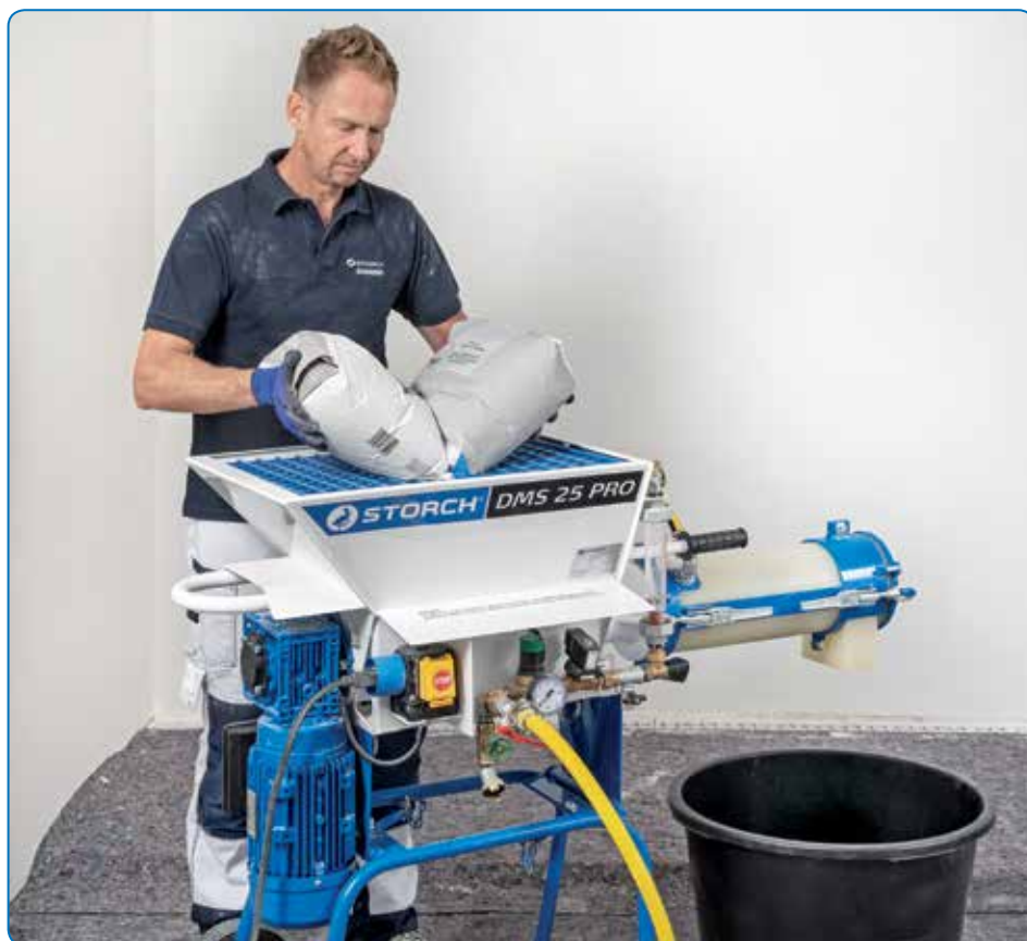
Grille de protection dentelée pour ouvrir et vider rapidement les sacs.
